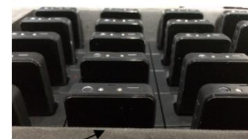
ヘッドホンジャックを上に向けて、アクリルパネル面を手前に向けてセットアップする。
