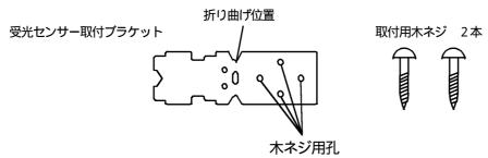
取付ブラケットの黒い面が内側になる様にして折り曲げ位置で90°位曲げます。 受光センサーの取付け位置を決め、添付の木ネジを使ってしっかりと固定します。 ネジ穴は、30mmピッチと24mmピッチの2方向から選べます。
