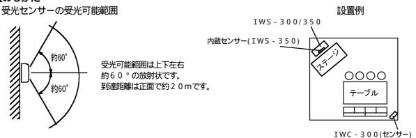
付属の受光センサーは、ケーブル長10mが付属されています。部屋全体を付属のセンサーで見通せるように 設置して下さい。
