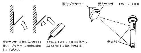
マイクの発光部と受光センサーは真直ぐに向きあっていた方が受光特性が良くなります。その為、本ブラケットは受光センサーの取付状況、マイクの使用状況に合せて受光センサーの取付角度を容易に変えられるようになっています。
