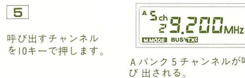
メモリーの呼び出しは周波数と同時にシフト方向、トーン周波数および、チャンネルロックアウトが呼び出されます。但しトーン周波数は表示されません。トーン周波数を表示させたい時はメモリーモードの時に[ENT]キーを押すと、その時のメモリーチャンネルのトーンコードが10kHzと1kHzの桁に表示されます。
